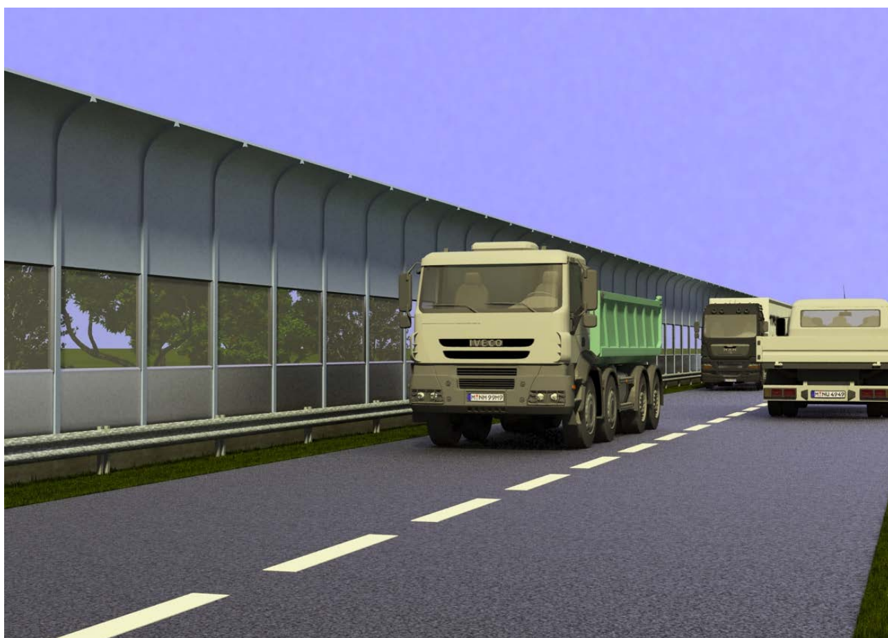
Фиг. 7.12 3-D визуализация от конкретен реализиран от СПЕКТРИ ЕООД проект за изграждане на противошумови бариери (предвидени като типово решение за описаните по-горе мерки с ИД № ВС1, ВС3, ВС4.
